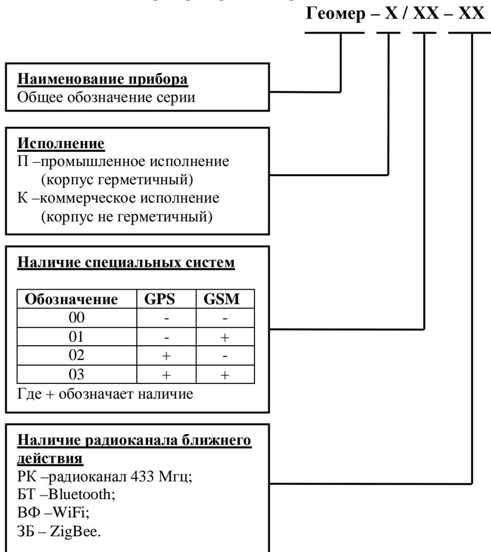
Пример обозначения прибора полной комплектации в герметичном корпусе, использующий в качестве радиоканала ближнего действия модуль РК на 433 МГц: «Геомер – П/03 – РК ТУ 6571-001-85008960-2008».
